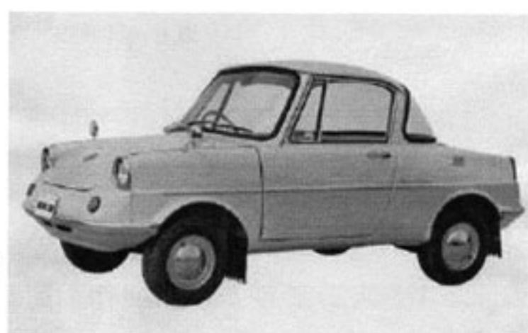
マツダの軽自動車「R360 クーペ」がお目見えした。軽量化したボディーに356cc空冷2気筒OHVエンジンを搭載し、リッターあたり32キロの低燃費を実現。
